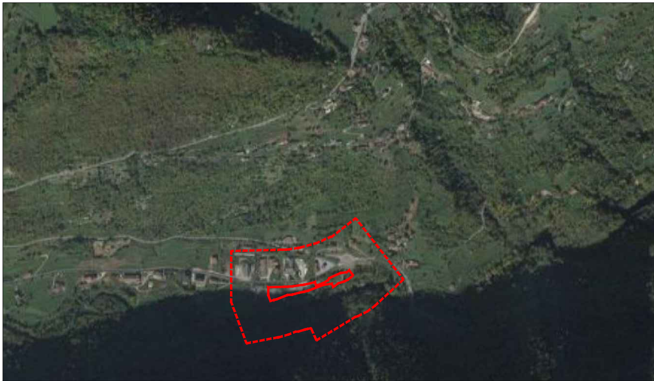
Vista Aerea (scala 1:10.000) — Recinzione di progetto del nuovo depuratore --- Fascia di rispetto di 100 m dalle abitazioni
